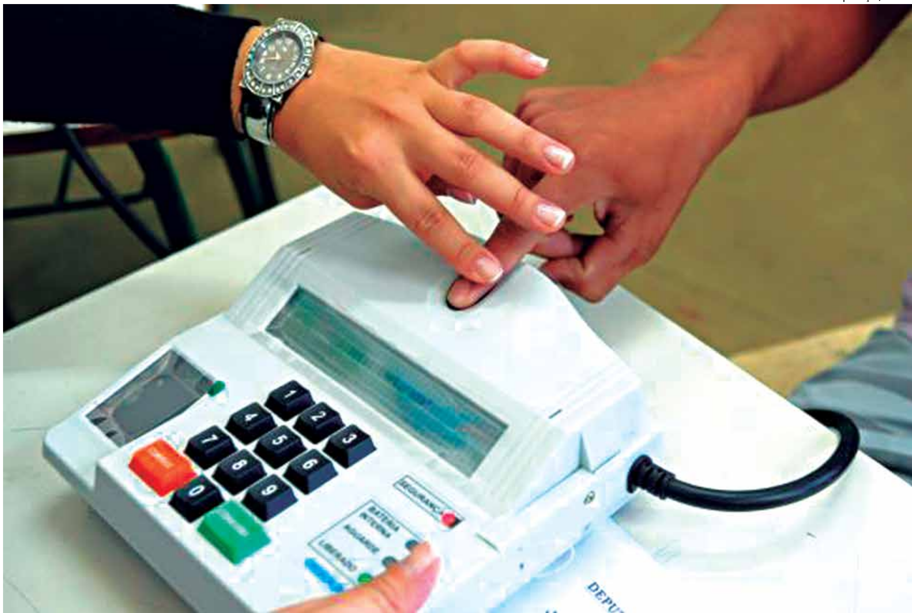
Urna biométrica com eleitor simulando o voto. As impressões digitais de uma pessoa são únicas e a comparação no banco de dados é feita por um programa
